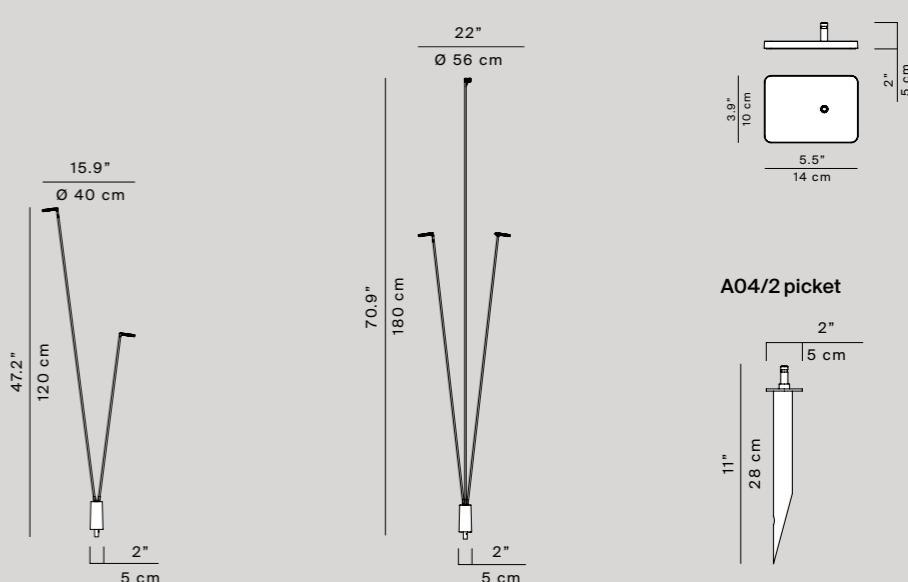
**Light source****A04TF1** LED 2,5W 3000K CRI 90 8,5V dc**A04TF2** LED 5W 3000K CRI 90 8,5V dc**A04TF3** LED 7,5W 3000K CRI 90 8,5V dc**A04TP1B / A04TP1C** LED 4W 2700K CRI 90 5V dc**Materials**
